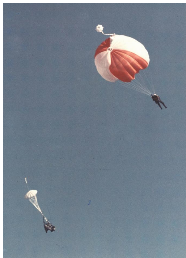
Provskjutning med docka från bil av andra generationens raketstol till Viggen. Saabfoto via SFF arkiv
