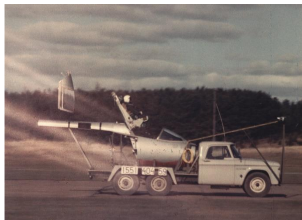
Provskjutning med docka från bil av andra generationens raketstol till Viggen Saabfoto vis SFF arkiv
