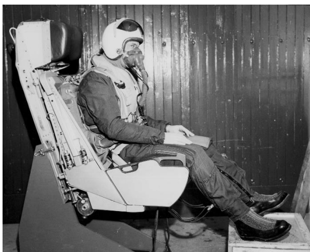
Katapultstol till fpl 37 Viggen med en pilot. Saabfoto Jan-Olof Petterson via SFF arkiv
