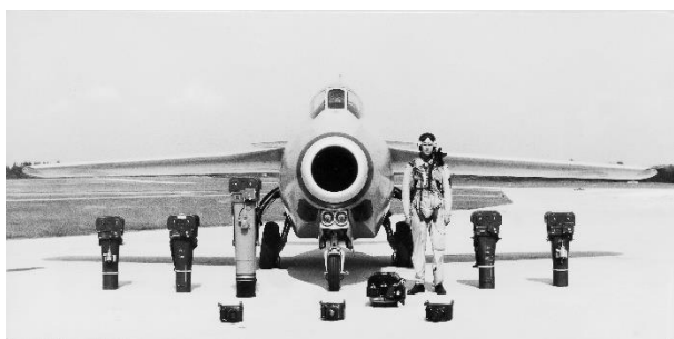
Spaningsflygplan S 29C Flygande tunnan, totalt 76 byggda. Avancerade kameror för lod- och avståndsfoto, men ingen beväpning. Periskop, bakomvarnare och viss annan utrustning eftermonterades. Senare sattes S 32C Lansen in för främst havsövervakningen
