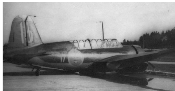
B 17A F 17-16 efter vådainsfällning av landställ 1949 Foto via G Alexander
