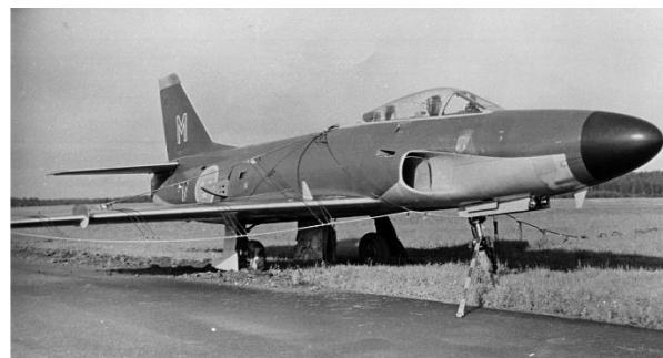
A 32 som hamnat i ”ryssjan” i slutet på bana 19 på F 17, relativt vanligt med fpl 32 och 35, enstaka fall med fpl 37 och SK 60. Generellt små skador på fpl – främst antenner och mindre plåtskador.
