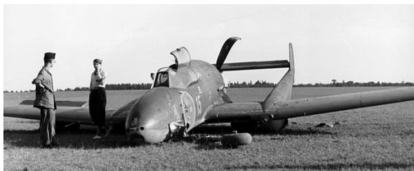
J 21 ur F 15 som inte kunde hålla kursen vid landning på en av gräsbanorna på F 17, hela landstället bröts därvid sönder. På den stora propellern på J 21 var landställsbena ovanligt höga och klena.
