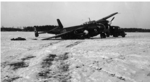
Denna T 18 blev under taxning påkörd bakifrån av ett annat fpl, det resulterade i en lång ”sladd” med höger landställ avbrutet och strukturskador i bakkroppen.
