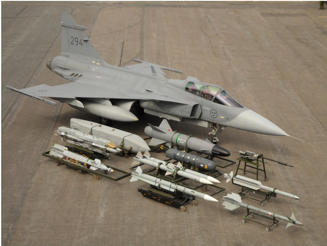
JAS 39C. Alternativen kan även bäras av JAS 39E. Vänstra raden: Fälltank stor FTS (på fpl), spaningskapsel SPK 39, styrda bomber GBU-39 och GBU-49. Mittraden: Sjömålsrb RB 15F, målutpek-/målinmätksel LDP, jaktrb RB 99 AIM-120 AMRAAM och jaktrb RB 101 Meteor. Högra raden: 27 mm akan m/85 Mauser, jaktrb RB 98 AIM-2000 IRIS-T, Jaktrb RB 74 AIM-9L Sidewinder Foto: Emil Lindberg
