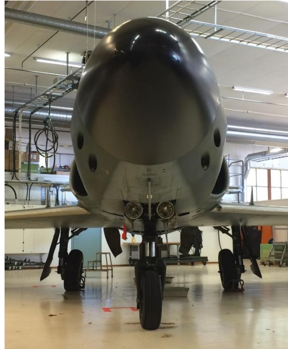
I detta perspektiv påminner Lansen lite om en haj. De fyra portarna för 30 mm akan syns tydligt. A 32A hade 20 mm akan där mynningarna skyddades av hydrauliska luckor. I S 32C fanns i stället kameror i nosen och plåtinklädnaden var annorlunda.
