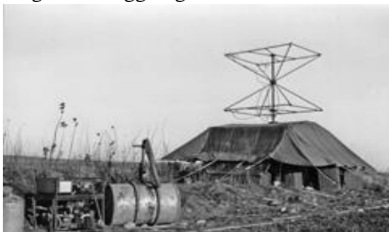
Den första luftbevakningsradarn i FV av typ ER3. Senare använd som landningsradar på flygflottiljer.
