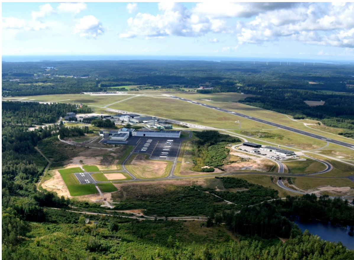
Ny helikopterhangar och platta samt FATO (start- och landningsområde) närmast. I fältets norra del, utanför bild, finns transportplatta, incidentplatta och beredskapsbyggnad samt drivmedelsanläggning.
