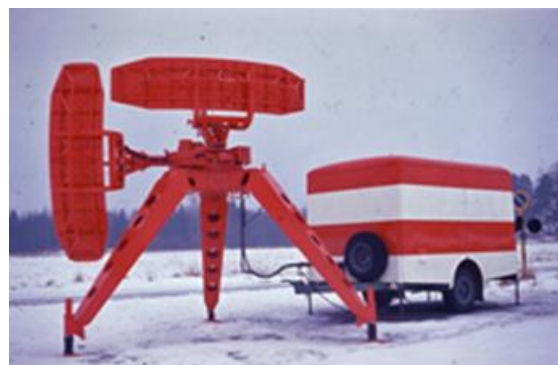
Landningsradar PN-67 PAR – P recision A pproach R adar. Med denna typ av radar kan man bokstavligen "tala ned" ett flygplan till landning.
