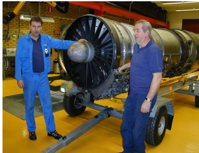
Motorverkstaden. Teknikern Anders Blomqvist (tv) och Per Fredriksson förbereder service på RM8.
