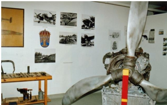
T 18- utställningen i dåvarande F17 förbands-museum, hösten 1999. DB 605 utställd i upp och nedvänt läge för att ge plats för propellern.
