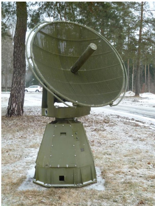
Antennen till väderradarn PV 30. Den finns placerad utanför Sleipner.
