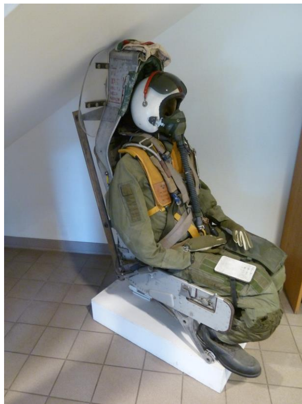
Katapultstolen till A 32 Lansens. Den finns för närvarande placerad i traditionsrummet.
