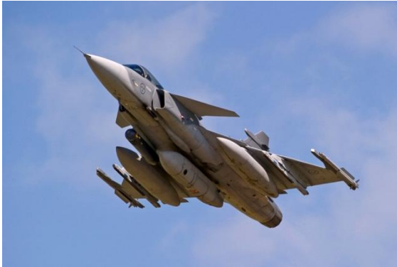
Ett JAS utrustat för spaning. Planet bär SPK (spaningskapsel) och LDP (laserpod), extratankar samt jaktrobotar för egenskydd.
