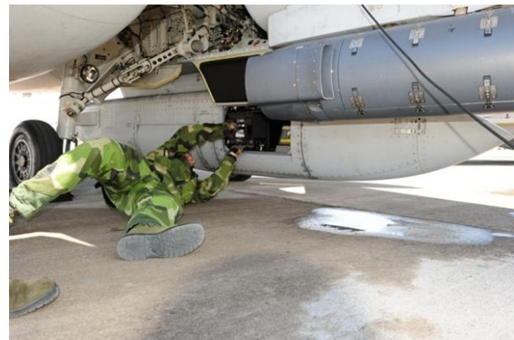
Plundring av sensor i spaningskapseln
