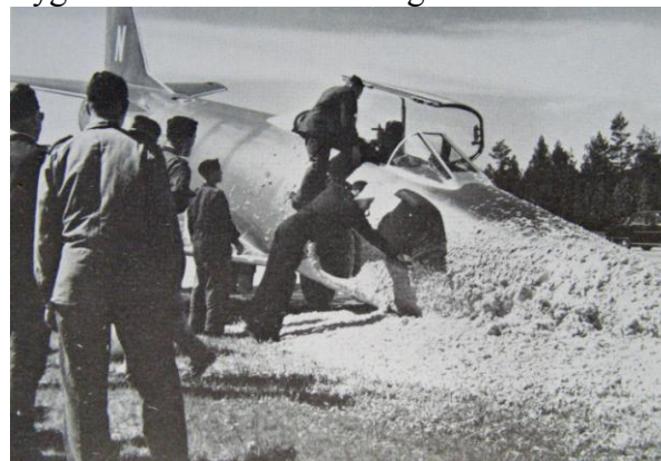
Noshjulet fälldes in vid landning.
