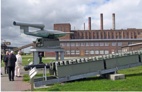
V-1 drevs av en pulsjetmotor och katapultstartades från ramp. I bakgrunden syns kraftverket.
