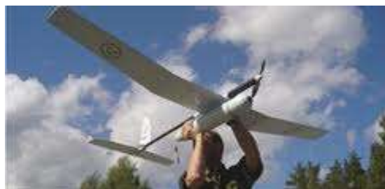
Falken är liten och lätt, endast några kilo. Den handstartas/kastas mot vinden, är batteridriven och kan genomföra åtta flygningar per laddning. Bild: FM
