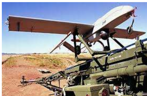
Örnen startas från ramp, drivs av en wankelmotor och väger 170 kg. Den har en räckvidd på 10 mil och flygtid på max 6 tim. Bild: FM
