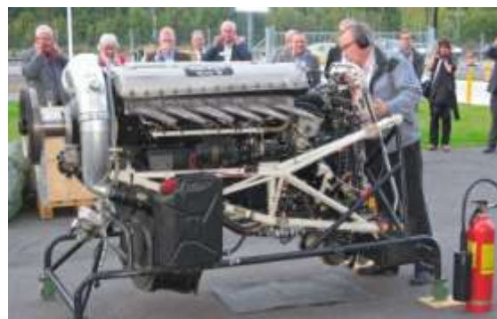
Lennart Öberg berättar om och kör en flygmotor RR Merlin 38, en gång monterad i kanadensisk Lancaster.
