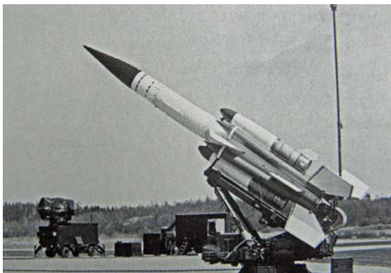
RB 68 Bloodhound 2, på sin lavett. Bakom syns belysningsradar samt robotgruppcentral, Rbgc.
