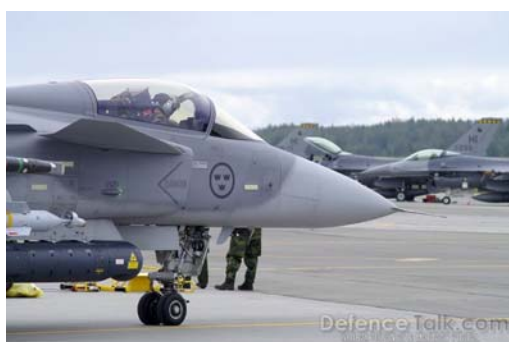
Gripen med precisionsvapnet GBU-12 och laserutpekarkapsel. Måldata erhöles antingen från marken eller från Gripens egen kapsel.
