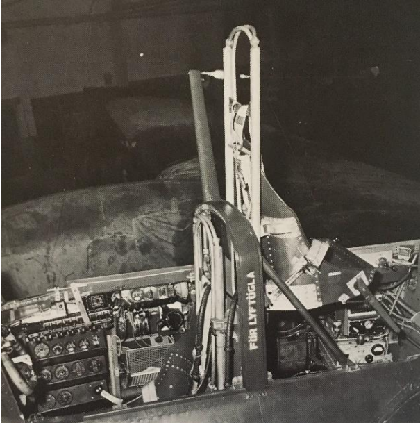
Katapultstolar eftermonterades i fpl typ B 18B och T 18B, ff stolen till vänster, signalistens stol upphissad.
