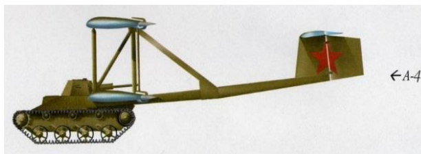
Flertalet större krigförande länder i 2.Vk experimenterade med lastglidare av olika slag. Bilden visar en rysk Antonov A-40 крылья танка (ung. "tankvingar"). Idén att sätta vingar på en stridsvagn visade sig dock vara alltför optimistisk (!)
