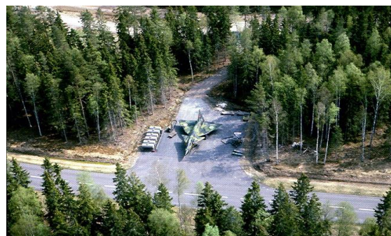
Så kallad ”flygplanficka” i ”Bas 60” – fasta rulltankar för bränslet och oftast viss klargöringsmateriel utlagd i förväg. I Bas 90 uppgaderades dessa platser med bl a kvalificerat datasamband mot flygbasen och STRIL. Ingen utrustning eller materiel lagrades på plats.
