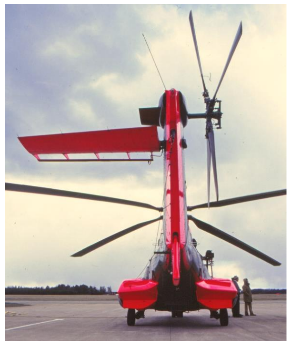
HKP 10 med stabilisator till vänster medan HKP 14 har den till höger. Foto: B Andersson.
