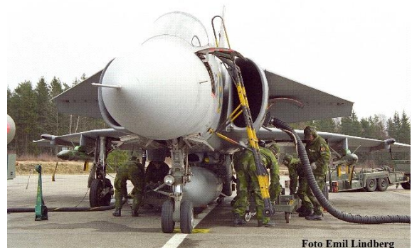
JA37Viggen förbereds för nästa uppdrag av en klargöringstropp, bl a hängning av robotar.
