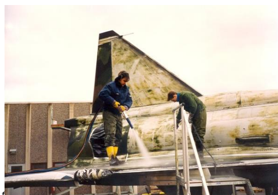
Mikael Polin och blästrare från Norclean genomför praktiskt prov med Armex sodablästring på en AJ 37 Viggen. Förefaller inte vara särskilt miljövänlig.
