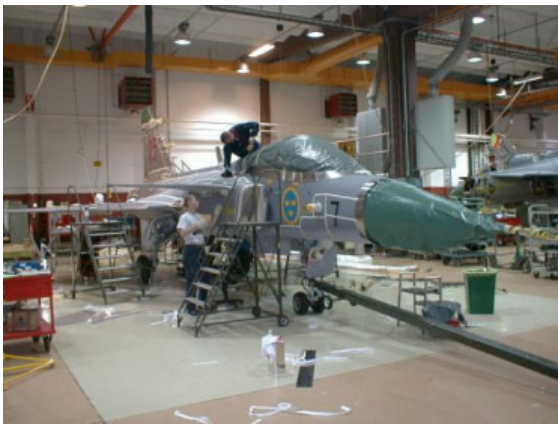
JAS 39 förbereds för blästring i målningsverkstaden. Metod för lättblästring med vetestärkelse.
