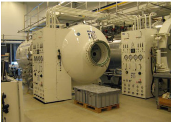
I tryckkammaren kan varierande djup och temperatur simuleras - ned till 160 meters djup under ishavs- till tropiska vattentemperaturer. Kontroll- och övervakningssystemet är helt automatiserat.
