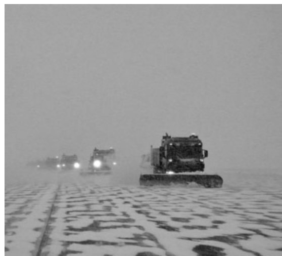
Vid kraftigt snöfall tillämpades system med plogbilarna tätt efter varandra, kort tid före start.
