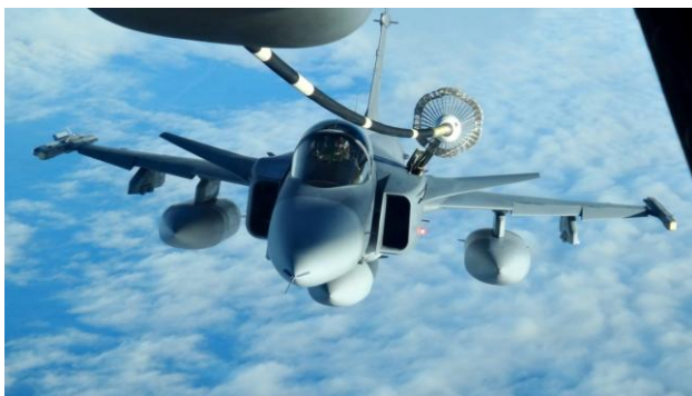
Bränsle påfylls genom en slang till JAS39C tankanslutning (probe) som fälls ut vid tankning.
