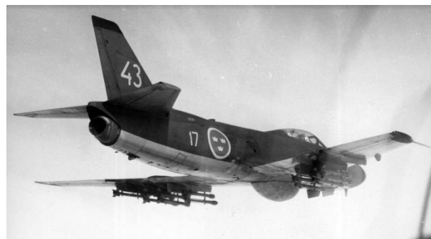
Q 43 hängd med raketer, dessa fanns i fyra olika diametrar mellan 13,5 – 18 cm för olika måltyper.
