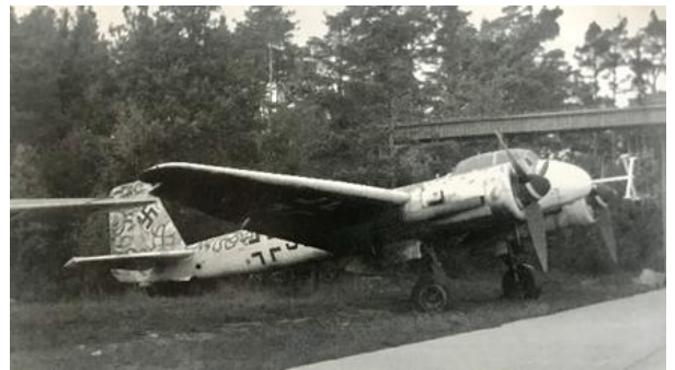
Den nämnda Ju 88:an parkerad vid Hangar 84 på F 17. I nosen syns den enkla yttre radarantennen. Ju 88 med radar användes främst i nattjaktförbanden.
