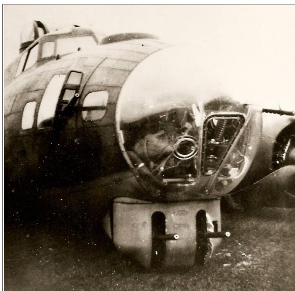
Under nosen finns beväpning i tornet och på kroppssidorna
